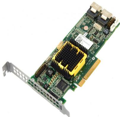
Adaptec ASR-5805 2244300-R 3 Gb/s 8 portas SAS/SATA RAID interno com cache de 512 MB
