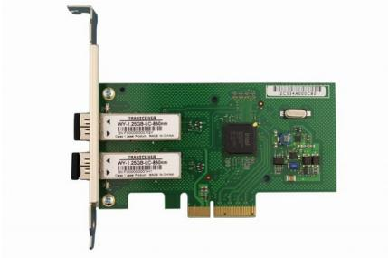
Adaptador de servidor Ethernet Intel I340 Gigabit Dual LC Fiber Port, 2 portas, LC, 1000, PCIe, 82580
