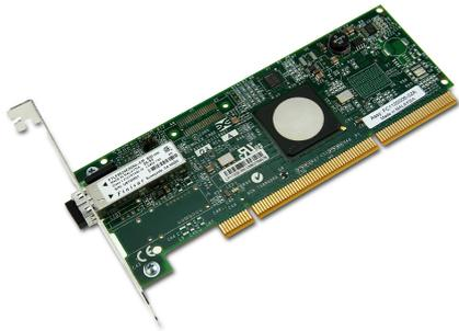
Adaptador de barramento host Emulex LP11000 4GFC PCI 2.0 de porta única Fibre Channel
