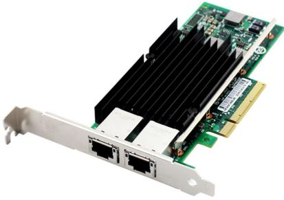
Adaptador de rede convergente Intel X540 10GbE Dual RJ45 Ethernet
