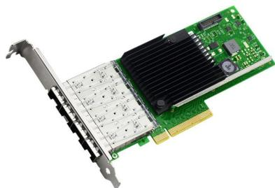
Adaptador de rede convergente Intel X710 10GbE Quad SFP+ Ethernet X710DA4G2P5
